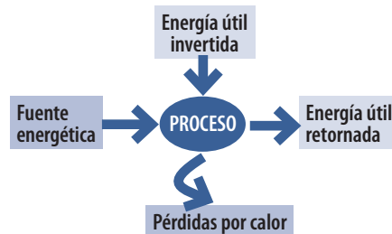
FIGURA 5: ENERGÍA ÚTIL INVERTIDA EN UN PROCESO DE TRANSFORMACIÓN DE ENERGÍA
